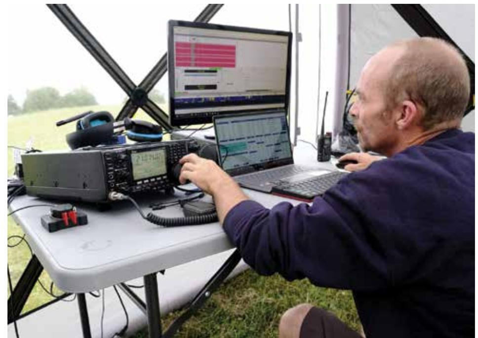
Une station numérique en fonctionnement. L'ordinateur est branché à la radio et établit automatiquement les contacts avec d'autres stations similairement équipées. L'opérateur n'a qu'à superviser. / A digital station in operation. The computer is connected to the radio and automatically makes contact with other stations that are similarly equipped. The operator only has to supervise. PHOTOS: CHRISTIAN ROCHEFORT
